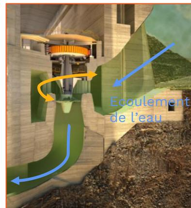
Vue 3D d'un groupe de production, en rotation sous l'effet de la chute d'eau
